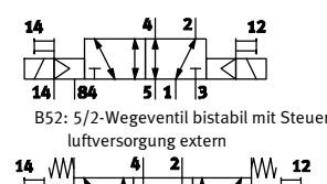
P53C: 5/3-Wegeventil mit Steuerluftversorgung extern, Mittelstellung geschlossen
