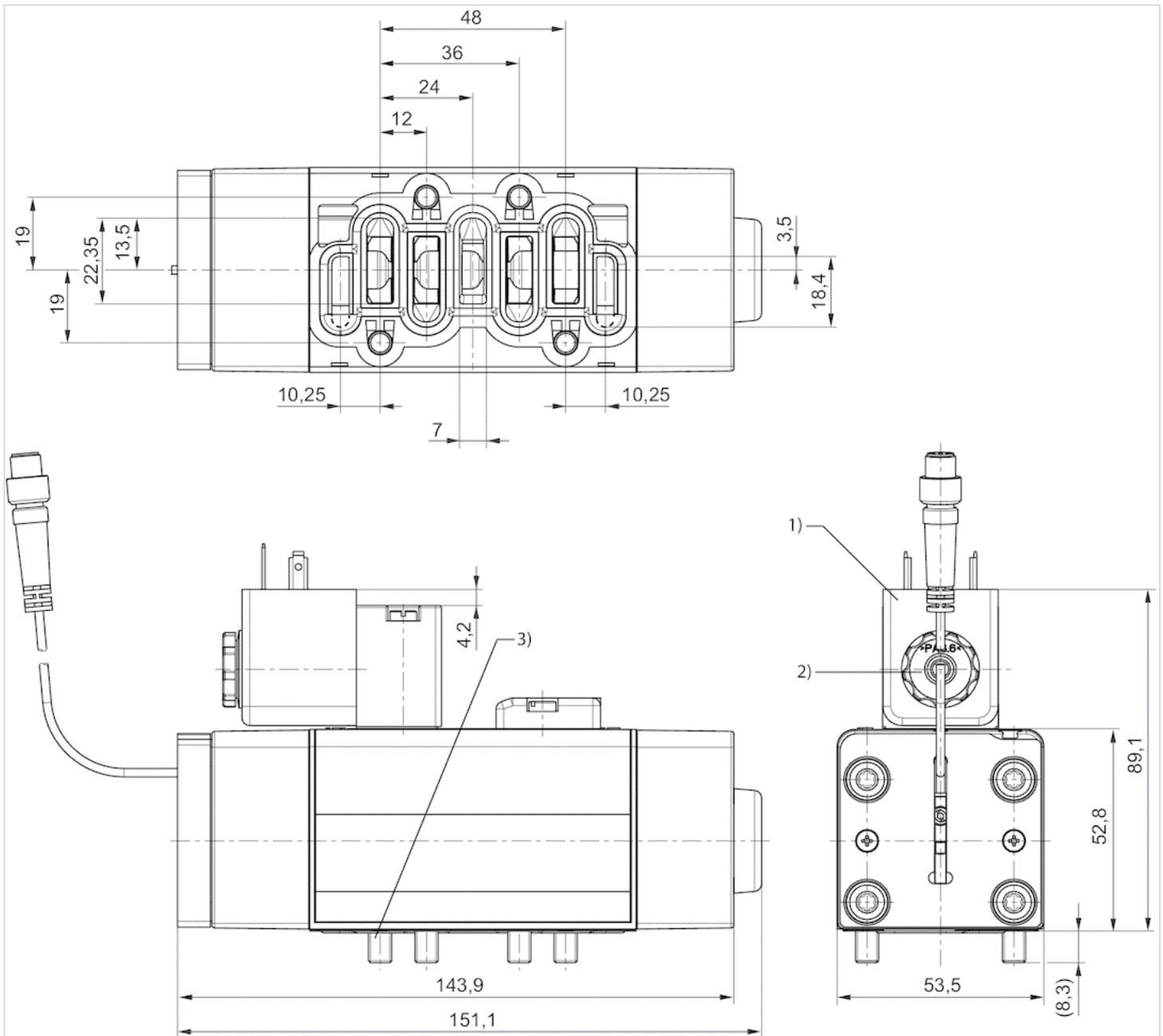
1) Verstellbare Spule 3x90° 2) Anzugsmoment für Befestigungsmutter: 0,6 + 0,2 Nm 3) Anzugsmoment für Befestigungsschrauben: 4,0 ± 0,5 Nm
